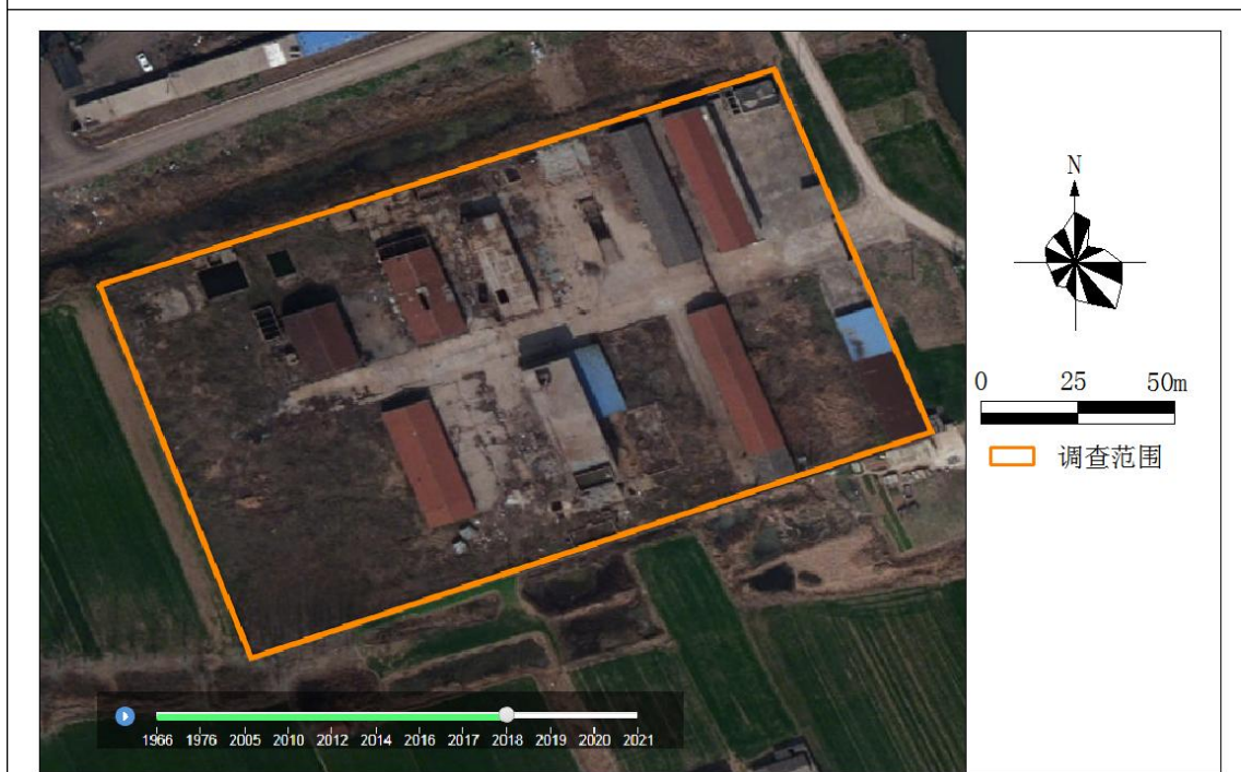
摄于 2018 年（摘自：天地图江苏）——地块内车间 2 东部墙体和部罐区已拆除，地块处于闲置状态。
